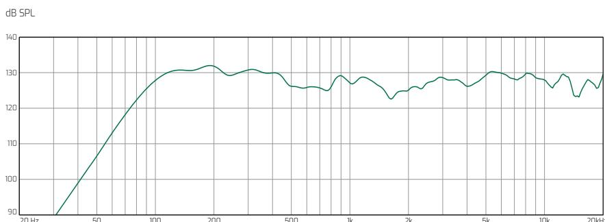
El gráfico muestra la respuesta de frecuencia para una señal sinusoidal barrida de 1 vatio en un entorno anecoico ( $4\pi$ ), medida a 3 m y reducida a 1 m.
